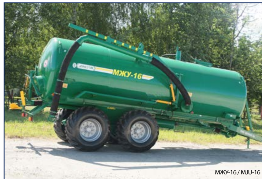
Машина для внесения жидких органических удобрений МЖУ-16/МЖУ-20А / Liquid slurry tankers MJU-16, MJU-20A
